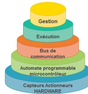
FIGURE 6. Hiérarchie de contrôle-commande
